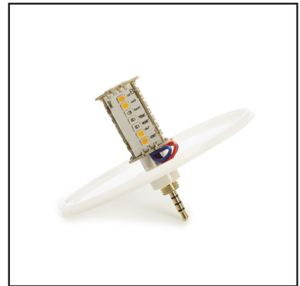
Phase 3: Um an die Klinkenbuchse zu gelangen, muss der Kopf vom Diffusor abgezogen/abgenommen werden.
