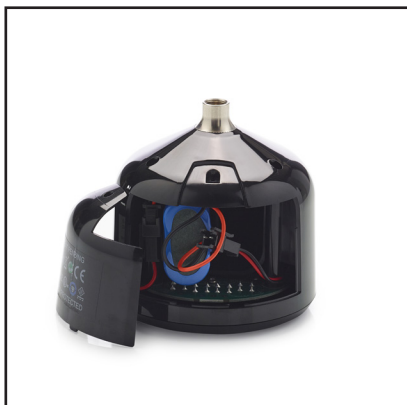
Phase 5: Entfernen Sie die Abdeckung des Batteriefachs.
