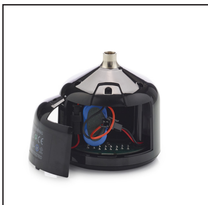
Phase 5 : remove the battery door
