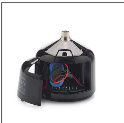
fase 5 : Verwijder de batterijdeur.
